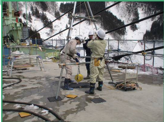
重錘落下試験の状況
